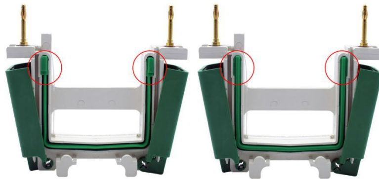
图2. 碧云天、Bio-Rad等公司的电泳槽U型硅橡胶密封条的突起结构图。由于碧云天的BeyoGel™ Elite PAGE预制胶的该部位是平的，使其兼容几乎所有厂家的小型胶电泳槽，所以电泳时须将具有突起结构的硅橡胶密封条(左图)取出后反过来安装(右图)，使其没有突起的平滑面朝外，从而防止漏液。
